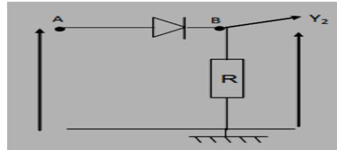
**b) Deuxième opération :** La détection de l'enveloppe et la suppression de la porteuse
